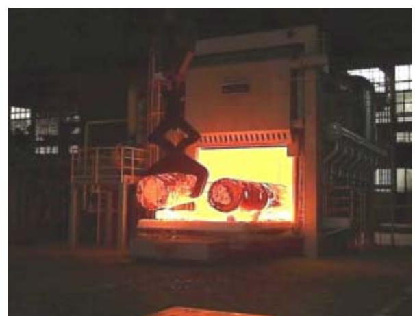
Bild 6 Schmelzofen: Temperaturen bis 1350°C; Kombimodul ALTRA 1600/ALSITRA 1400
